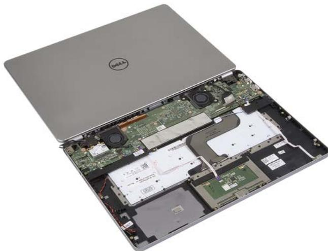
5 Retire los tornillos que fijan las bisagras de la pantalla al ensamblaje del reposamanos.
